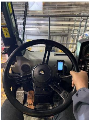
Bluewake installé dans un camion Caterpillar 793
